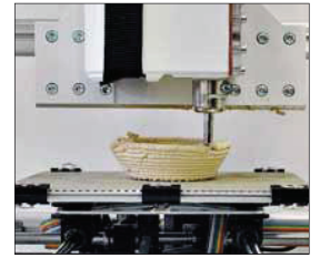
3D-Druck mit pastöser Holzmasse Foto: Uwe Bodenschatz
